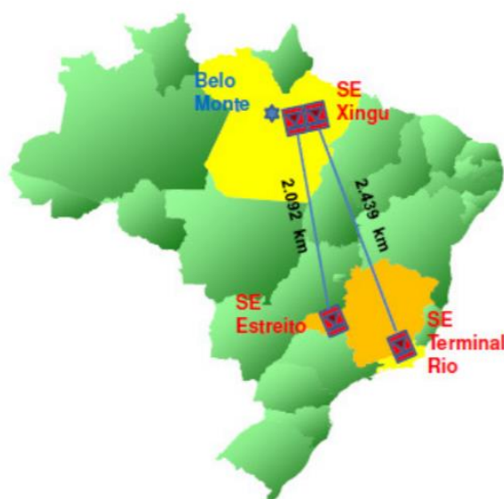
Bipolos em \pm 800 kV CC para expansão da interligação Norte - Sul
