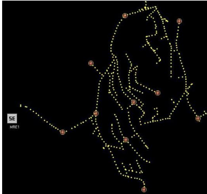
Figura 10: Perfil de tensões de um dado alimentador para o cenário “Sol Forte em Dia Frio-23” com GD distribuída em 10 pontos
