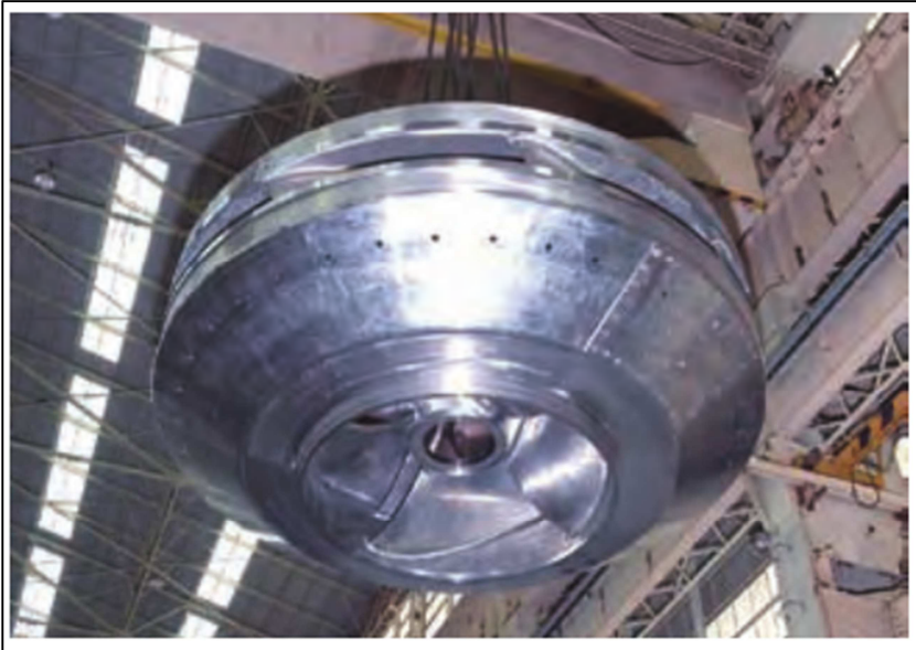
Figura 17: Desenvolvimento da turbo-bomba com palhetas intermediárias pela Hitachi
