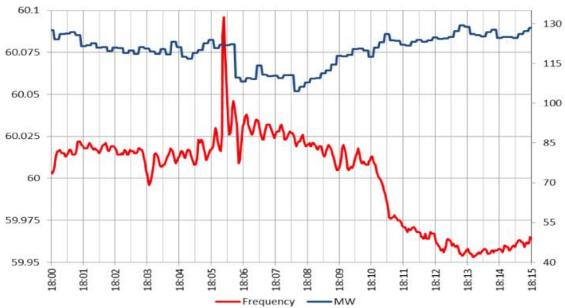
Figura 2 - Resposta da geração eólica à sobre frequência (Fonte: ERCOT).
