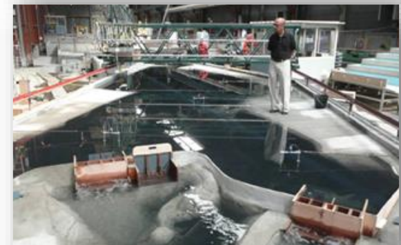
Testes em modelo reduzido no Instituto Sogreah (França) para avaliar o transporte de sedimentos através das casas de força e vertedouro .
